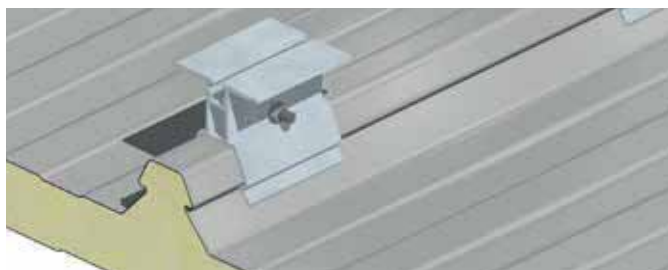
Detalle enganche de accesorios para cubiertas
