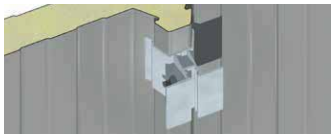
Detalle enganche de accesorios para fachada
